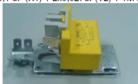
Condensateur Anti-parasite 0,1 uF (X1) + 2x0,027uF(Y2) + 1M Ω
