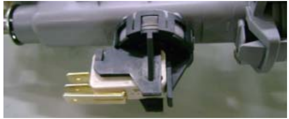
Distributeur Position 1 : Bras supérieur Position 2 : Bras inférieur
